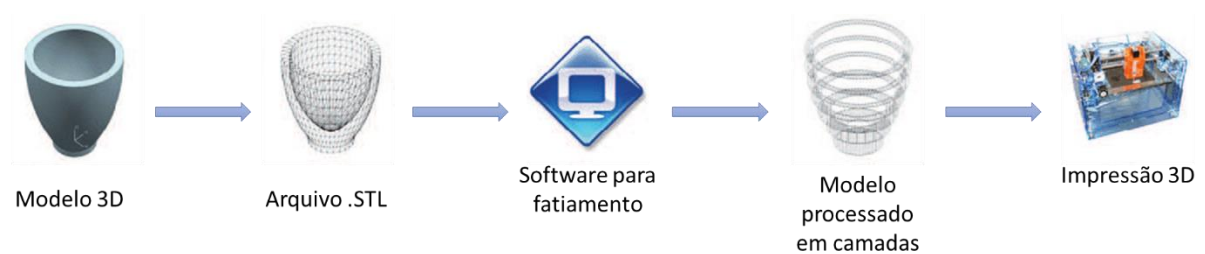
Figura 7 – Processo de fabricação em impressão 3D (Adaptado de NOORANI, 2017).
