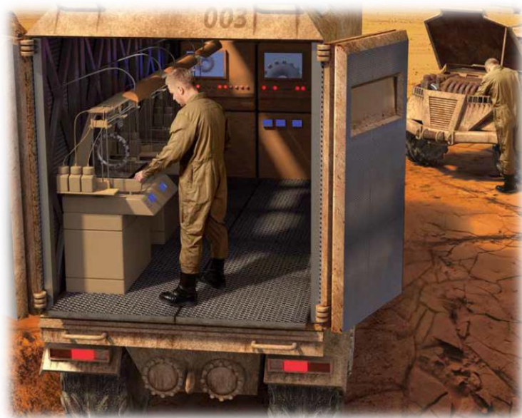
Figura 16 – Impressão 3D de peças de reposição em instalações móveis terrestres (LOUIS; SEYMOUR; JOYCE, 2014).
