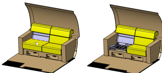
Figura B.0.11 – Familiarização – Substituição Painel Traseiro (Fonte: o autor).
