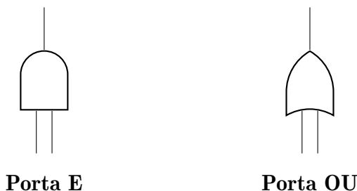
FIGURA 3.1 – Simbologia gráfica das portas lógicas “E” e “OU” utilizadas na árvore de falhas.
